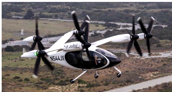
Foto: Joby Aviation. Her vises første testflygning der flyet flys rett opp vertikalt, deretter horisontalt, og så vertikalt igjen før landing.
