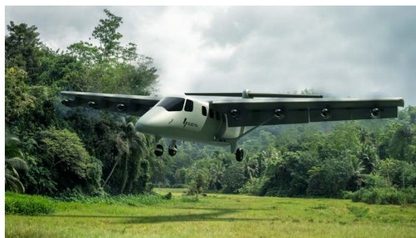
Illustrasjon: Electra VoltAero. EL9 utvikles til kunne lande på primitive og ekstremt korte rullebaner.
